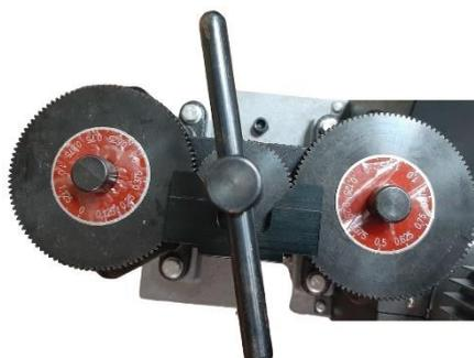
Во время эксплуатации валцов необходимо производить смазку. Масло необходимо добавлять в четыре небольших отверстия, показанных на рис. ниже. Периодичность смазки – каждый час работы валцов. Рекомендуется использовать трансмиссионное масло.
